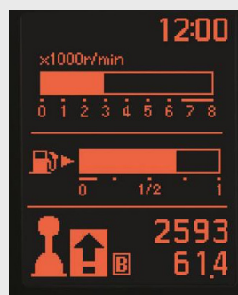
Fedélzeti számítógép sebességváltást segítő kijelzővel
